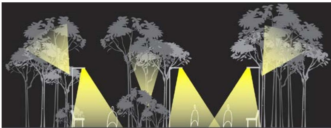
В рамках модернизации системы паркового освещения устаревшие осветительные приборы заменяются современными приборами с уличной асимметричной оптикой, направляющей световой луч строго на пешеходную дорожку.
