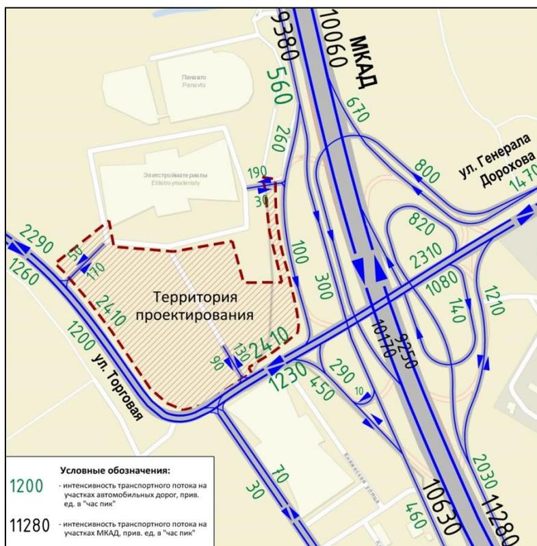
Рис. 3.2.3.1 Моделирование транспортных потоков. Утренний «час пик»
