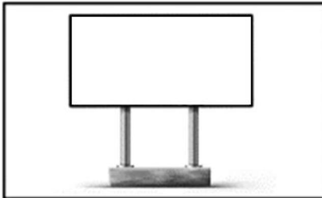
Информационный щит размерами XXXX на XXXX предполагается выполнить на бетонном основании (фундамент), опоры металлические трубы диаметром XXX, поверхность металлокаркас обшитый профлистом. Размещение в данном месте не препятствует обзору автодороги и не скрывает иные указательные знаки. Размещение информационного щита позволит без ущерба безопасности движения доносить информацию до водителей.
