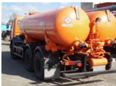
Рис. 5.1. Вакуумная машина КО-505А на шасси КамАЗ-65115-71
