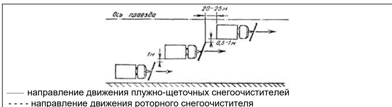
Рис. 6.5. Схема расчистки проезжей части улиц колонной плужно-щеточных снегоочистителей и складирование снега в лотке
