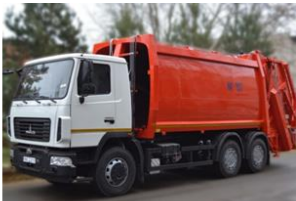
Рис. 4.15. Мусоровоз с боковой загрузкой КО-427-90 на базе шасси МАЗ-6312С3
