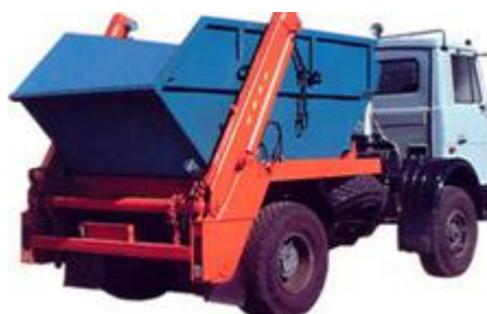
Рис. 4.16. Бункеровоз МКС-3501 на шасси МАЗ-5551А2
