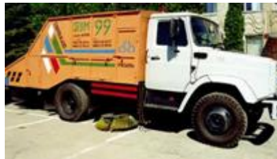
Рис. 6.18. Вакуумная подметально-уборочная машина ПУМ-99 на базе шасси «Зил».
