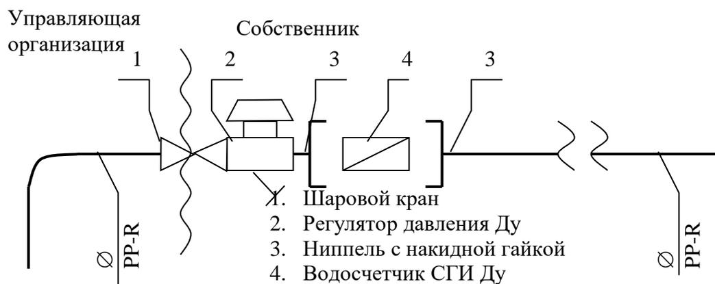
Исполнитель несет ответственность за надлежащее состояние и работоспособность систем горячего и холодного водоснабжения согласно нижеуказанной схеме до волнистой линии слева (включая шаровой кран).
