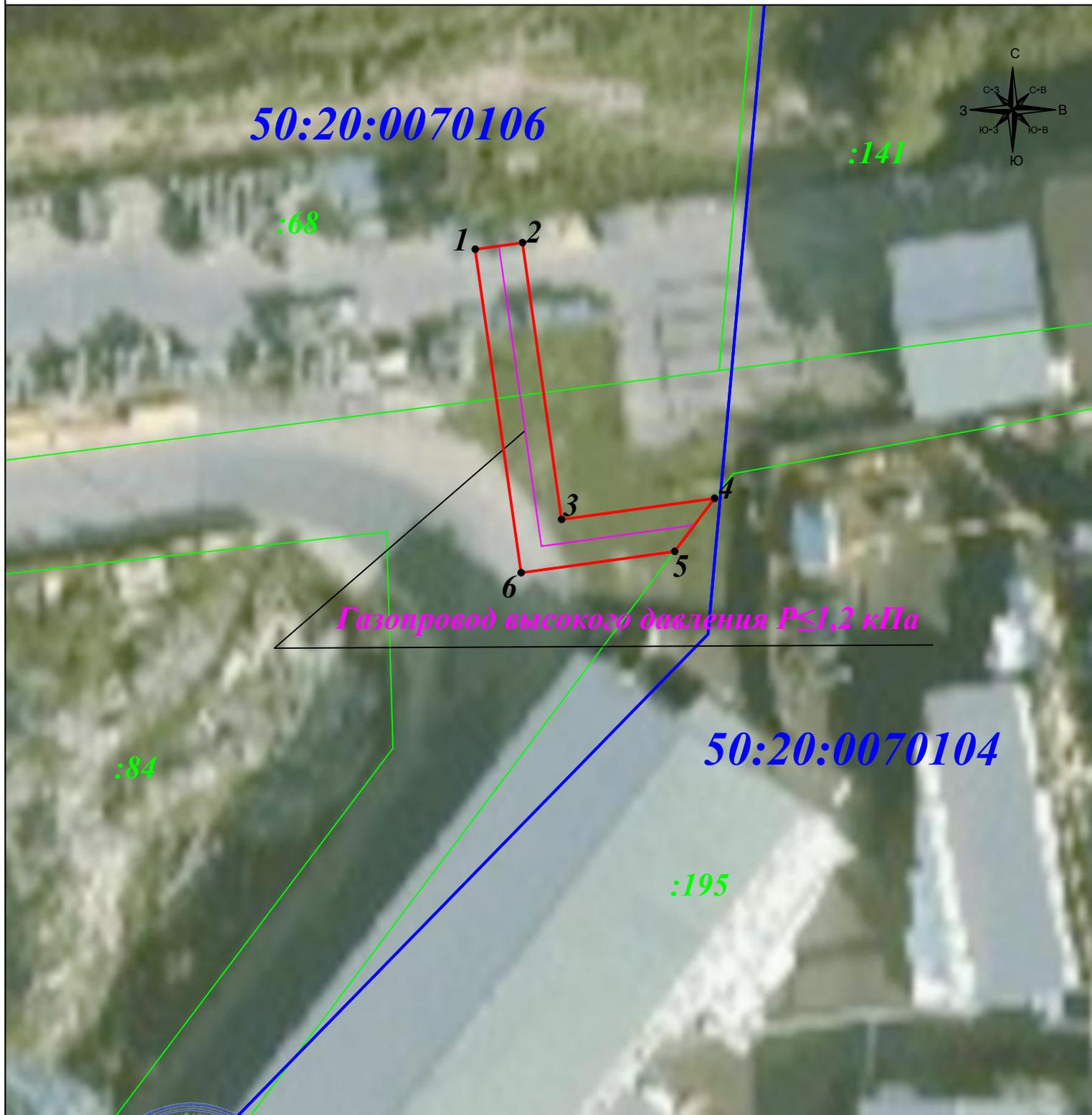
Газопровод высокого давления  $P \leq 1,2$  кПа
