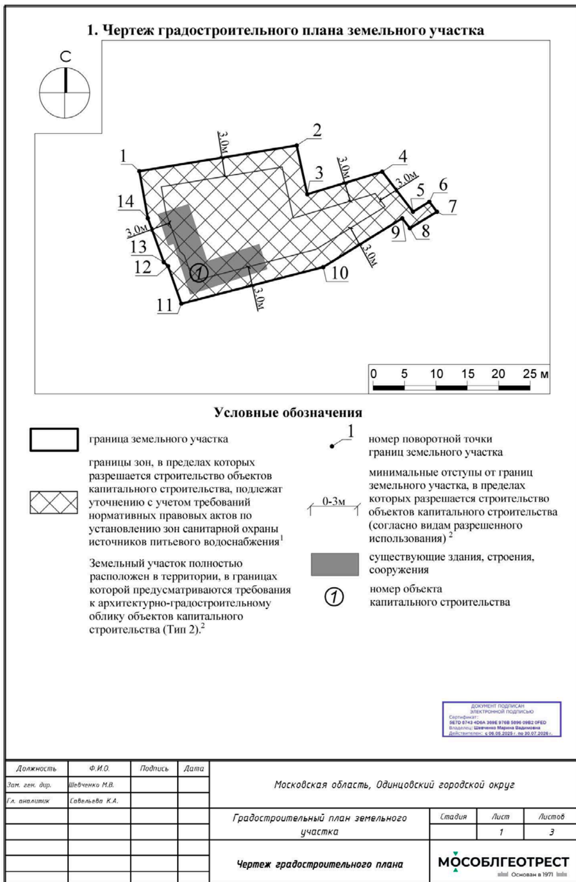
Рисунок 2 – Чертеж градостроительного плана земельного участка
