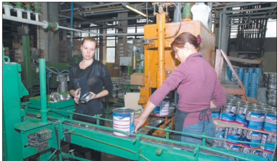
• Машинисты расфасовочно-упаковочных машин (РУМ) Татьяна Моргачёва (справа) и Оксана Автеева фасуют краску.
