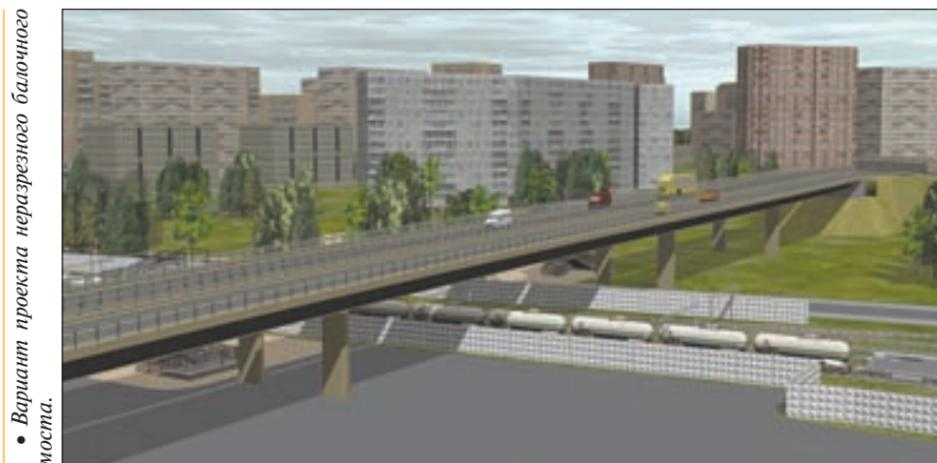
• Вариант проекта неразрезного балочного моста.
