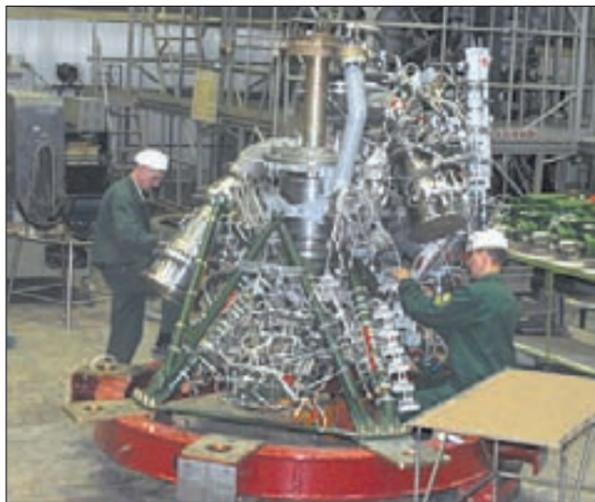
• Каждая деталь ракетного двигателя кропотливо собирается вручную.
